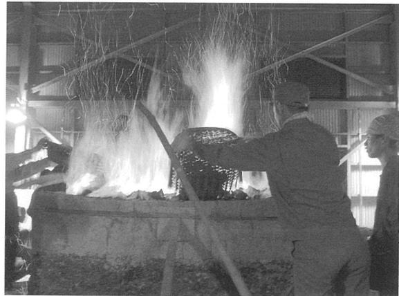
写真7 新見市中世たたら製鉄再現の様子（左：砂鉄装入 右：木炭装入）
