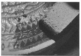
図5 砥粒と皮革で研磨加工した鋸歯文
