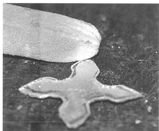
砥石で端部を仕上げる
