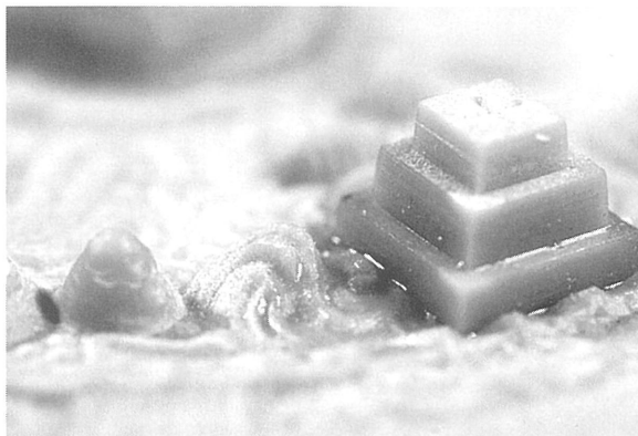
図2-5 抜けの勾配3.1度（垂直に近い）の突起
