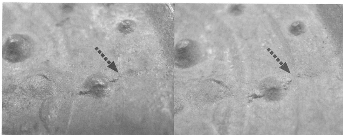
図4-22 鋳型Uから作られた同範鏡の1面目（左・U1鏡）と2面目（右・U2鏡） （突線が短くなる事例）
