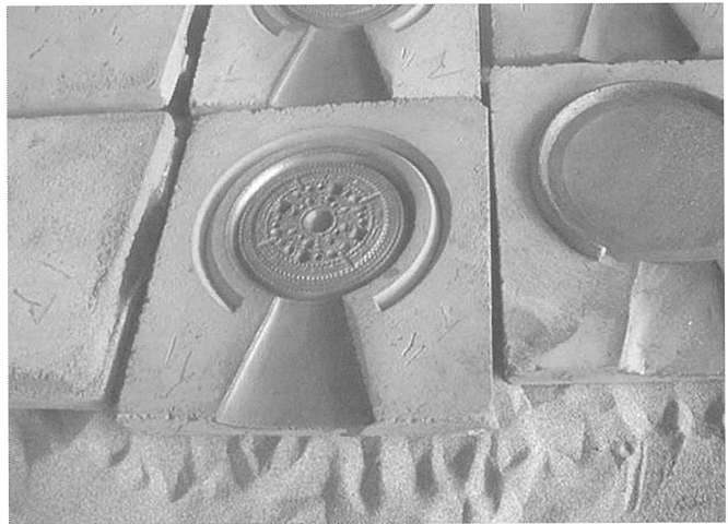
図 3-2 黒鉛を塗って乾燥中の鋳型
