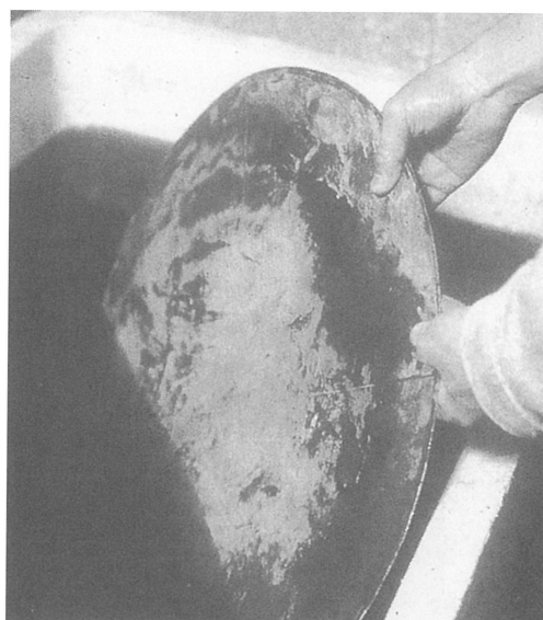
図9 焼き純しの終了した銅板を水で冷却したあと15%の希硫酸水溶液に5～10分浸し、表面についた黒い酸化膜を取り除く
