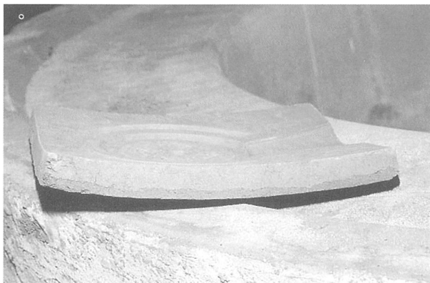
図3-23 バイメタルのように湾曲した二層式鋳型
