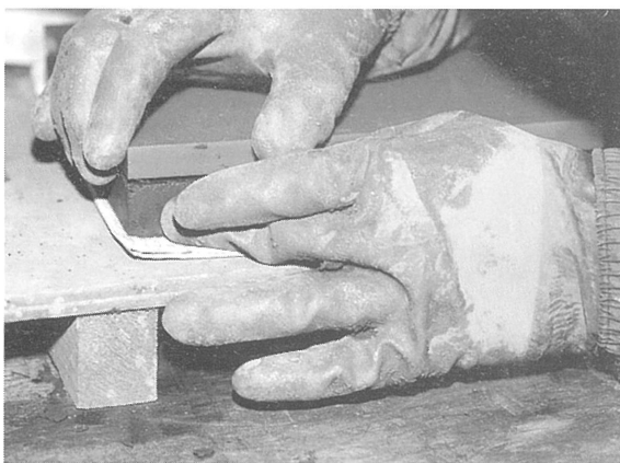
図2-10 鑄型と原型を剥離する
