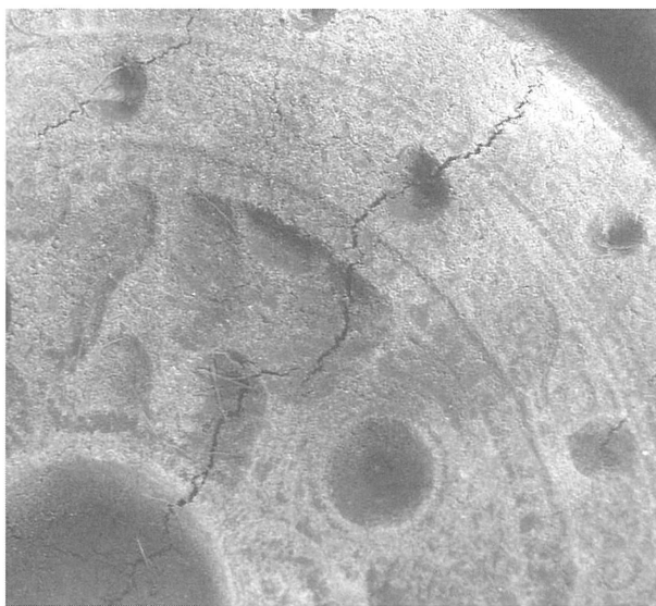
図3-25 ひびが入った二層式鋳型の表面（鋳型U） 上段と下段左は、乾燥後・焼成前、下段右は乾燥・焼成後
