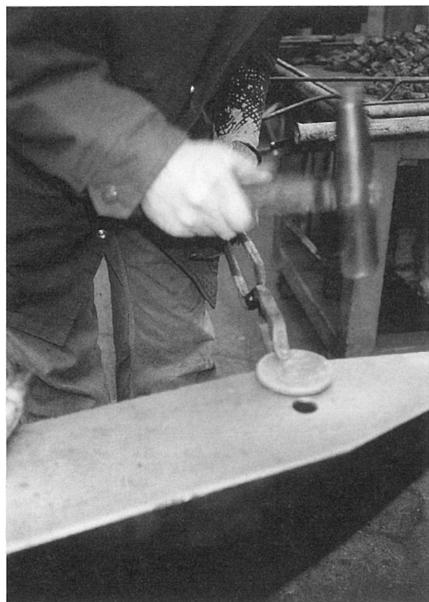
図5 鍛造し、形を整える
