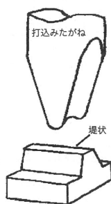
図5 堤状に加工された銅板
