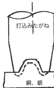
図6 打込みしたところ
