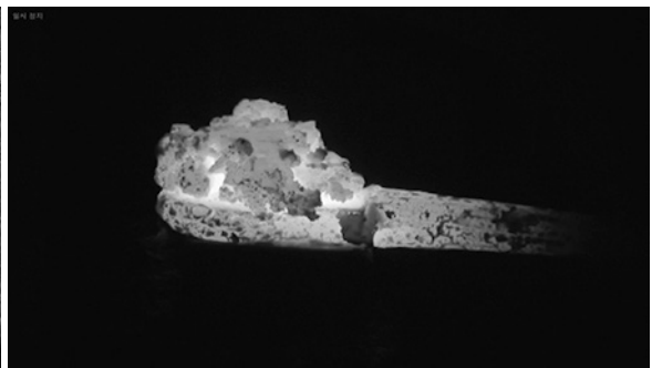
写真48 玉鋼の沸かし
