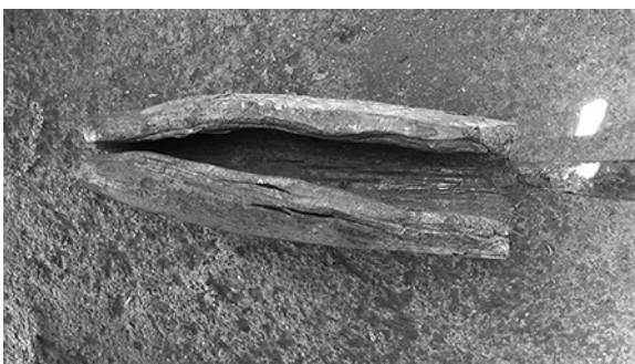
写真123 2次皮鉄の完成
