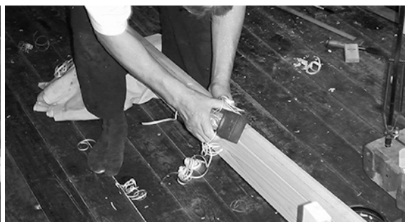
写真33 鞆の外側を削る
