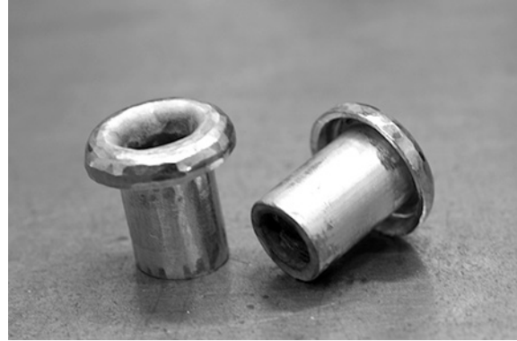
図4-8 紐懸通孔の筒金具4 縁を曲げる
