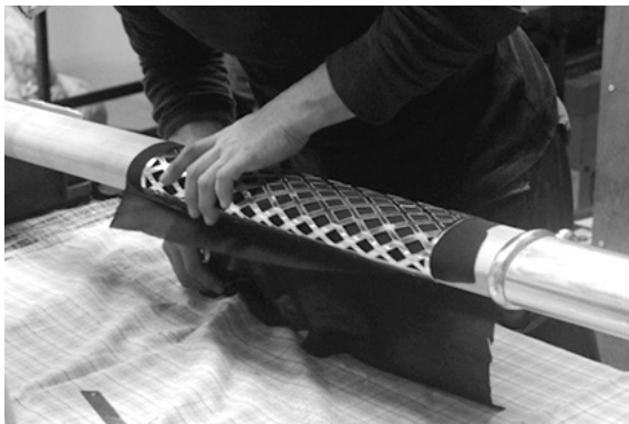
図4-21 鞘に絹布を巻き佩裏の菱形文飾板を被せ
