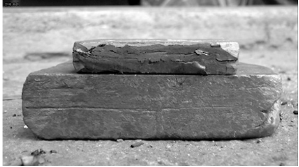
写真113 下鍛えした短冊と「5枚の短冊を接合した大きい皮鉄」
