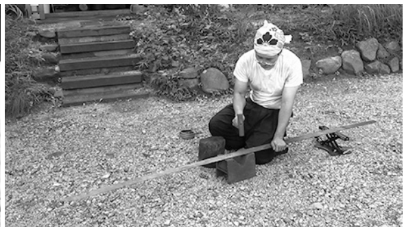
写真203 手鋸で刀身の歪みを整える
