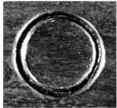
図31 円弧状なめくりたがねで仕上げ(復元)
