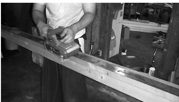
写真204 刀身表面の凸凹をなくす
