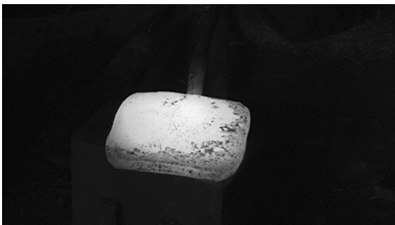
写真143 「5枚の短冊を接合した大きい塊」鍛造
