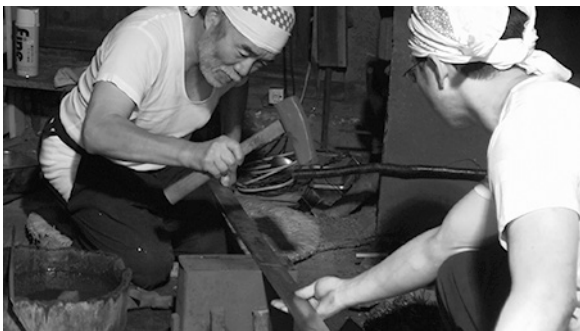
写真202 手鋸で刀身の歪みを整える
