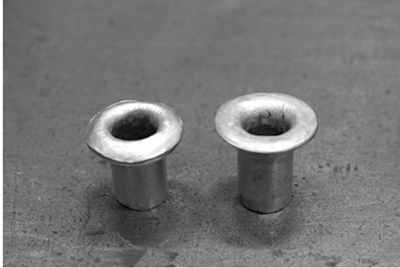
図4-7 紐懸通孔の筒金具3 縁を開く
