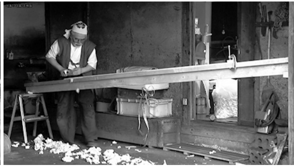
写真23 鉋で木製刀身の表面を削る
