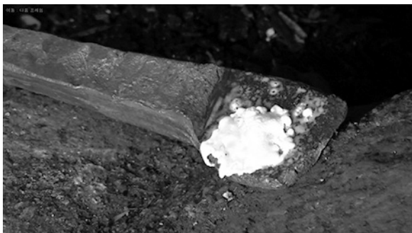
写真27 テコ棒の先端に硼砂をまく
