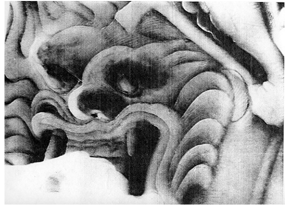
図65 藤ノ木馬具の鞍金具把手下海金具鬼神像(X線)の左手近くの鑄掛けの痕跡
