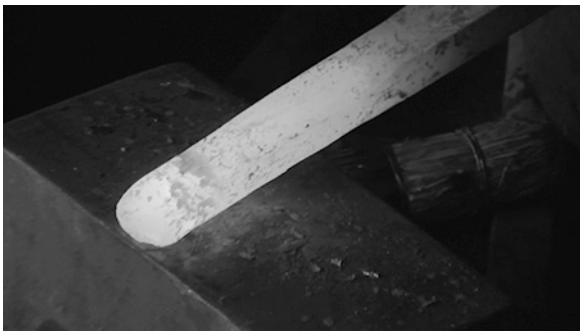
写真37 手鉗で心鉄の先端を薄く鍛造
