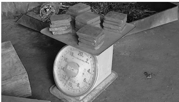
写真63 短冊の重さ測定
