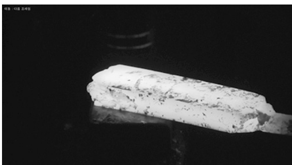
写真102 直方体の形に鍛造
