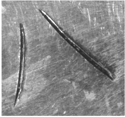
③「八」銘大刀のなめくり引き (両側にカエリが大きい)
