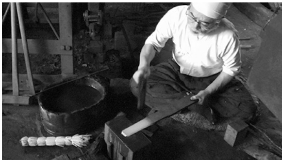
写真173 試作の火造り
