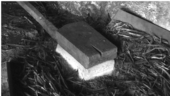
写真114 「5枚の短冊を接合した大きい皮鉄」2つを重ねる
