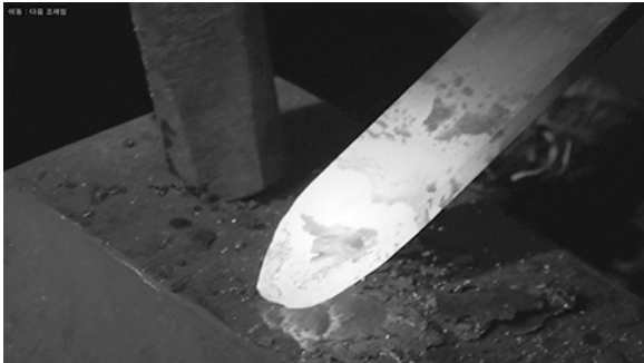
写真178 切っ先を尖らせるように鍛造
