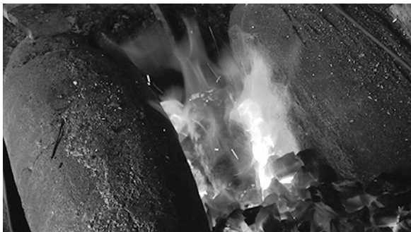
写真153 「3次組み合せた鉄塊」の加熱
