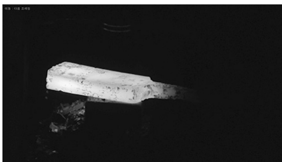
写真131 塊を直方体の形に鍛造
