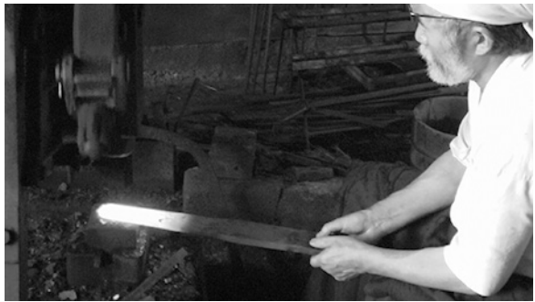
写真172 試作の火造り
