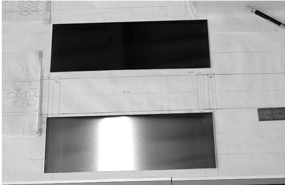
図 3-10 筒金具の地金取り。下は原寸図面が見える
