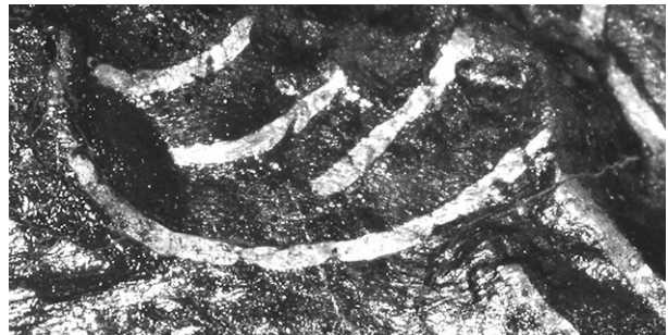
図33 同大刀の円弧状なめくりたがねの痕跡(矢印部分)
