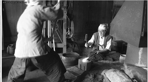
写真26 テコ棒の先端の鍛造
