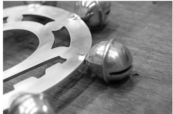
図4-4 ピンを差し込み鈴を固定
