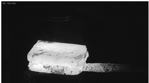
写真117 「5枚の短冊を接合した大きい皮鉄」鍛接
