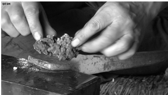
写真43 テコ棒の先端に玉鋼を乗せる
