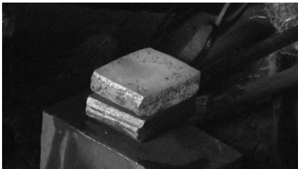
写真140 「5枚の短冊を接合した大きい塊」2個を重ねる
