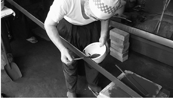
写真210 刀身に焼刃土を塗る
