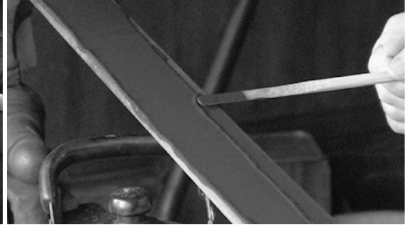
写真211 刃先部分には焼刃土を薄く塗る
