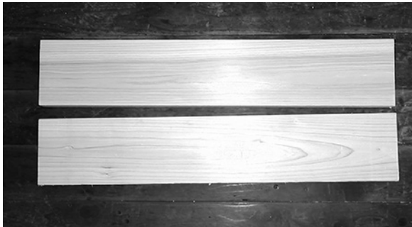
写真3 670×124×37mmの大きさにする
