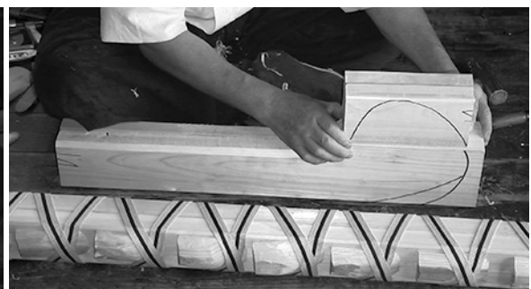
写真21 そくいで接着させる
