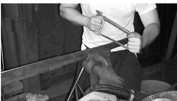
写真231 茎を所定の寸法に切る
