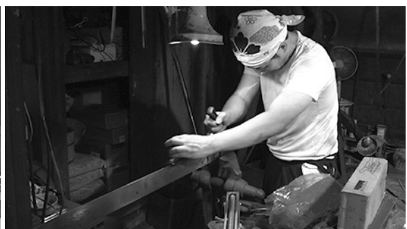
写真205 刀身表面の凸凹をなくす
