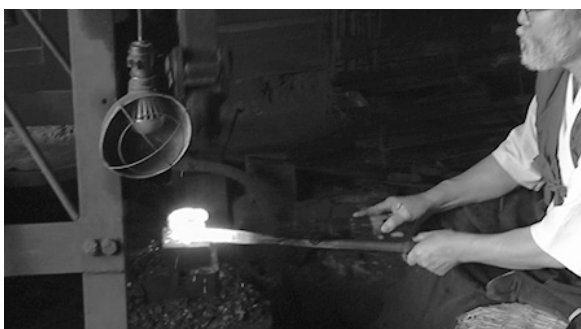
写真31 機械ハンマーで鍛錬
