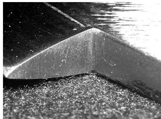
図6 復元七支刀（脱炭して層状になる）
