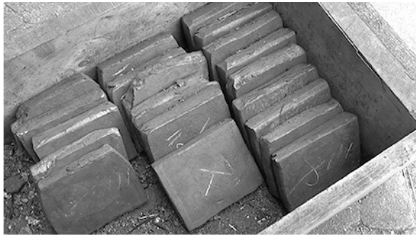
写真62 下鍛えした短冊の完成
