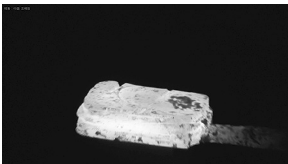
写真130 塊を直方体の形に鍛造
