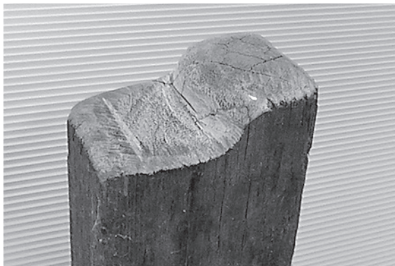
図1-14 溝加工用の木型
