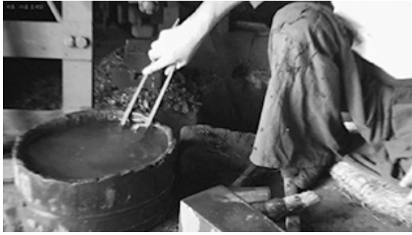
写真41 心鉄を水の中に入れて冷やす
