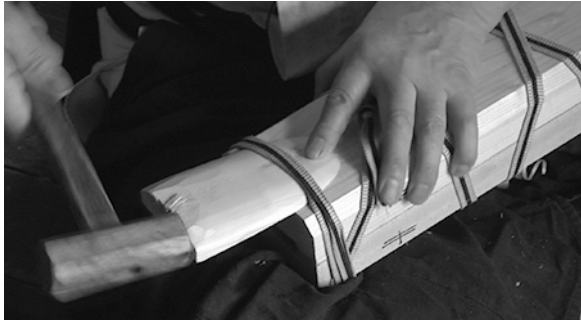
写真16 楔を打ち込む
