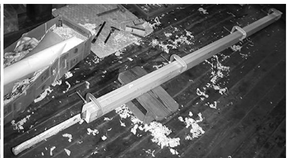
写真14 鞘を万力で仮止め
