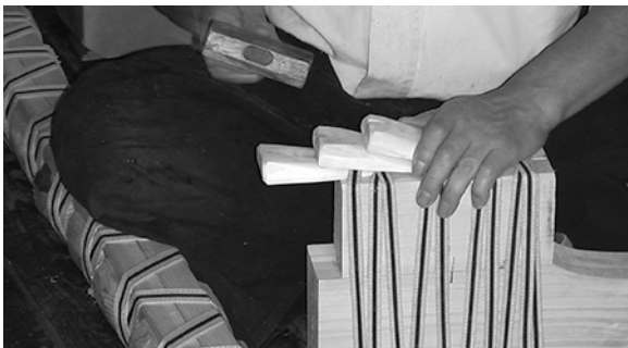
写真23 楔を打ち込む
