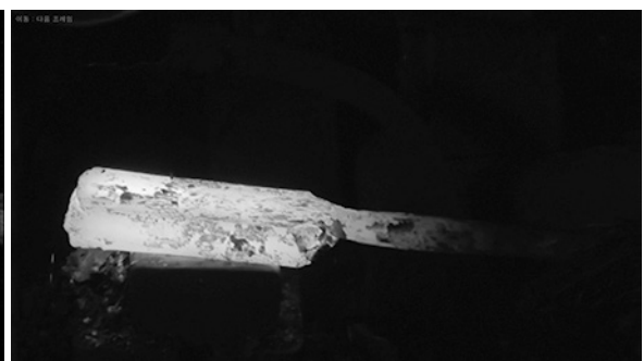
写真71 直方体に鍛造
