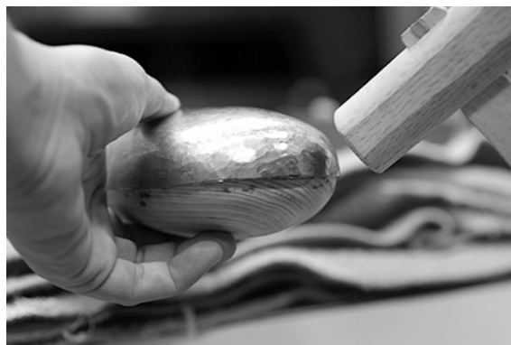
図3-14 銅板の絞り加工
