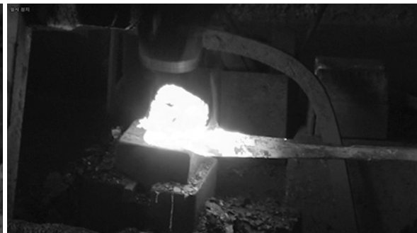
写真44 機械ハンマーで鍛造
