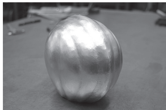
図1-19 銀ロウによるロウ付け接合
