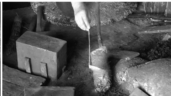
写真152 「3次組み合せた鉄塊」に泥を付ける
