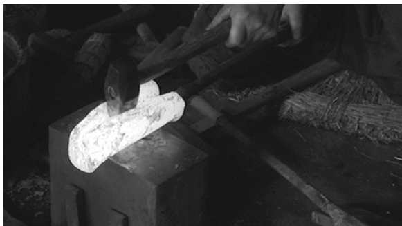
写真124 2次皮鉄の成型
