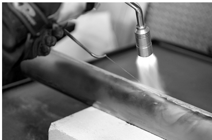
図3-15 鞆尻金具のロウ付け
