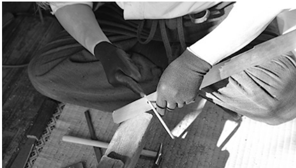
写真238 穴のバリを取る
