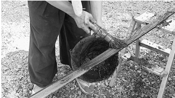
写真206 水に藁灰を混ぜて刀身を洗う
