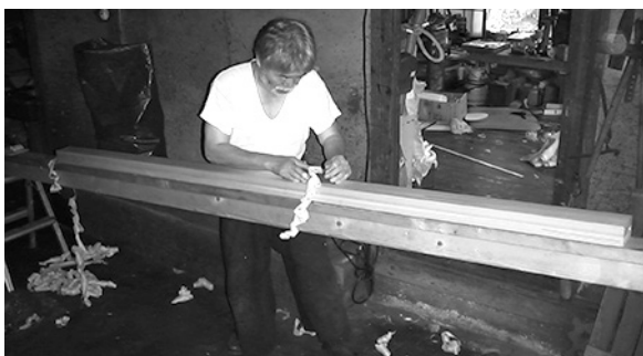
写真32 鞆の外側を削る
