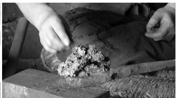
写真32 新しい玉鋼を乗せる
