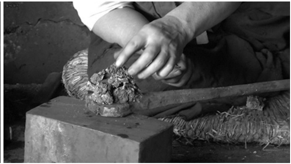
写真46 新しい玉鋼を乗せる
