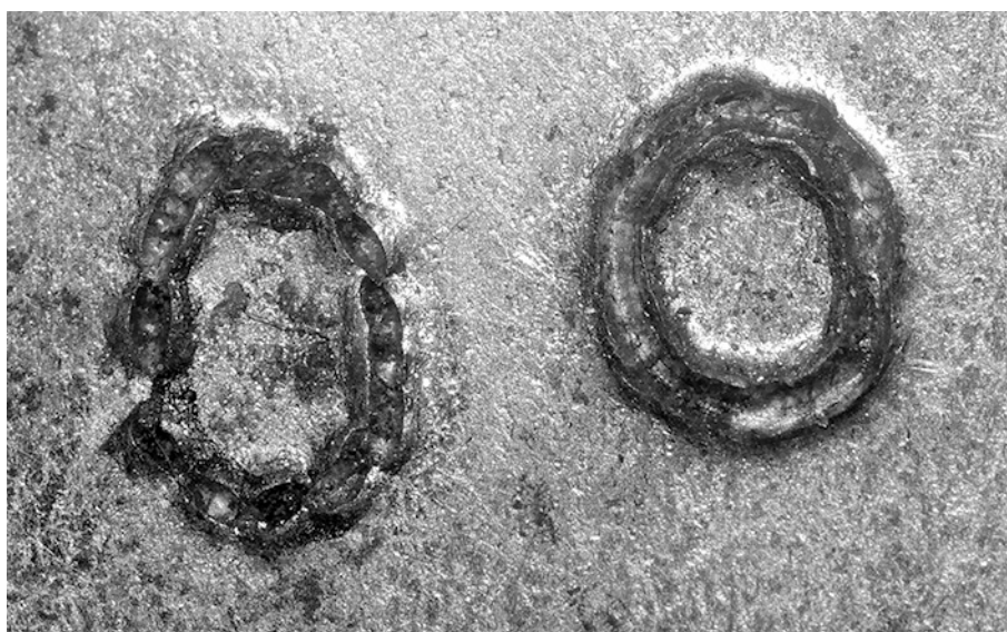
図23 なめくりたがねを打ち込み(左)さらに加工ピッチを細かく打ち込み、なめらかな円文に仕上げた(右)
