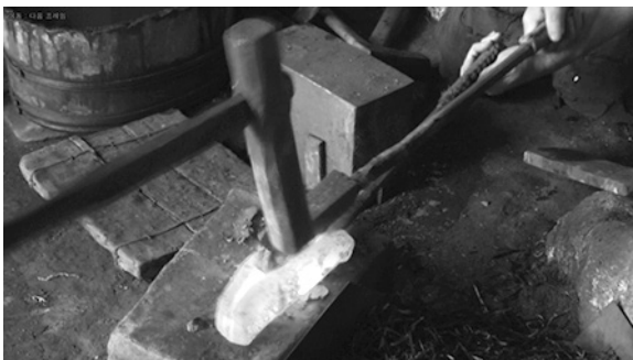
写真125 1次組み合せた鉄塊を2次皮鉄に入れる
