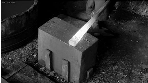
写真25 テコ棒の先端の加熱
