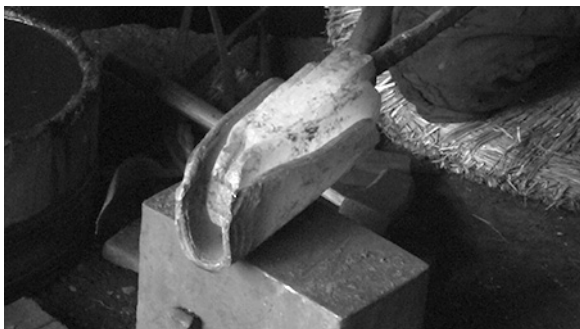
写真151 「3次組み合せた鉄塊」の加熱
